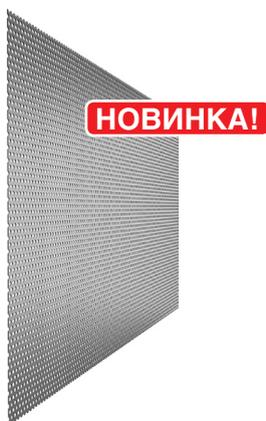
Алюминиевая решетка изготавливается методом перфорации из листа алюминиевого сплава. Данный способ изготовления обеспечивает оптимальное соотношение прочности изделия и веса. Для снижения возможных деформаций листа его дополнительно прокатывают через прессующие валки, металл становится более плоским, зато возрастает устойчивость к деформациям.
